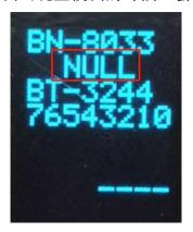
按液晶显示按钮切换到通讯板液晶界面,可显示模块型号、设备名称、软件 版本、模块故障。
